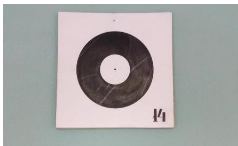
Рис. 1. Фотография визирной марки на стене аудитории
