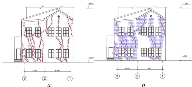
Рис. 3. Принципиальные схемы ремонта фасада здания Ляпинской ГРЭС в осях «3-1»:
