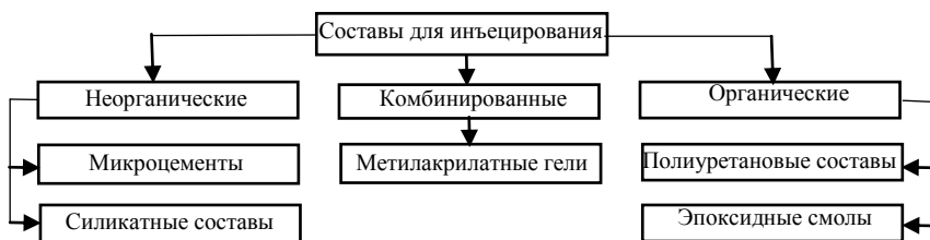
Рис. 2. Современные актуальные составы для инъецирования кирпичной кладки
