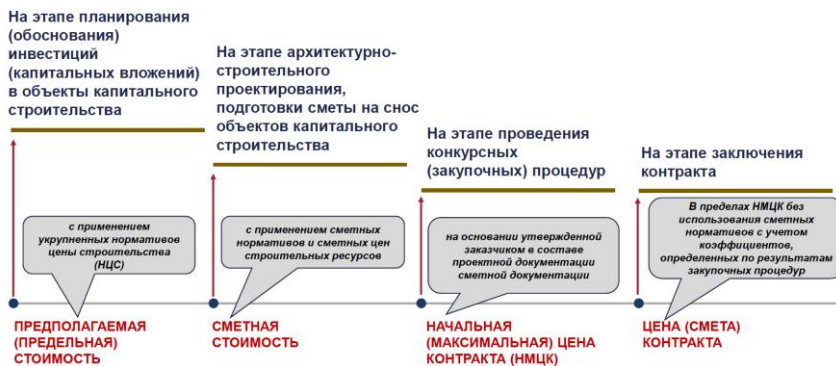
Рис. 1. Этапы определения стоимости в строительстве
