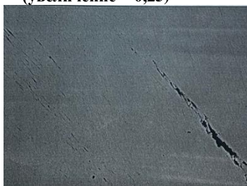
Рис. 4. Микроструктурное исследование разрыва (увеличение \times 0,95 )
