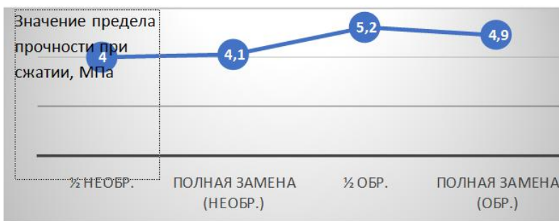
Рис. 2. Зависимость предела прочности при сжатии от обработки металлургического отхода
